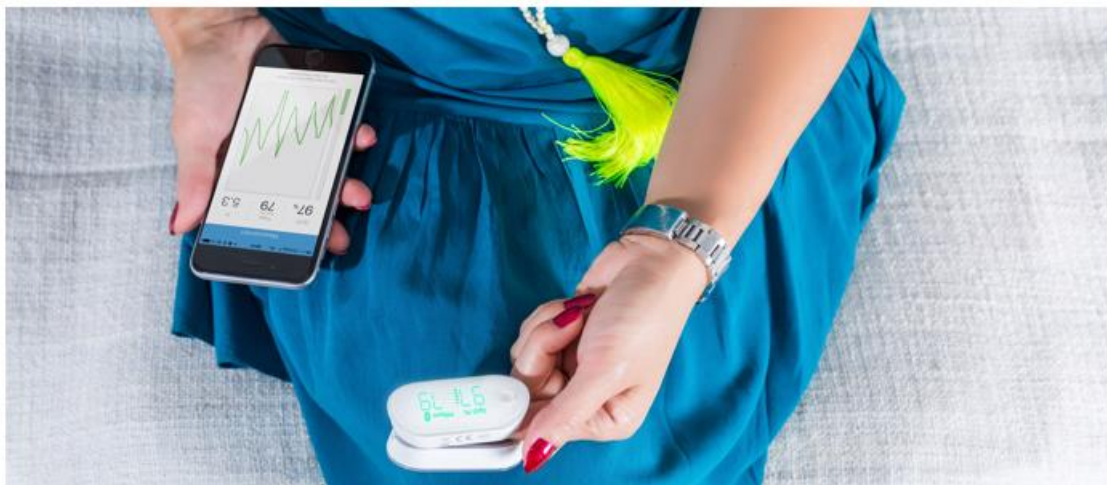
Obr. č. 8 Konektivita iHealth AIR PO3 s mobilnou aplikáciou. Zobrazenie aktuálnych nameraných hodnôt na mobilnej aplikácii.
