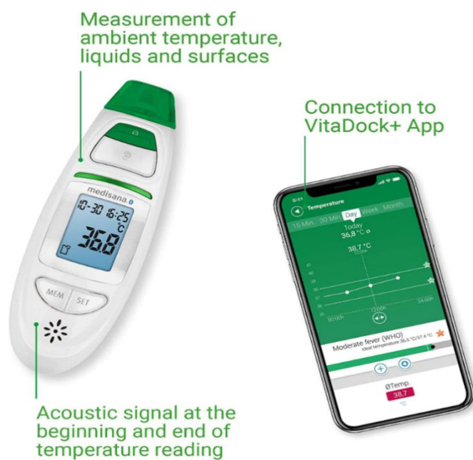
Obr. č. 23 Konektivita teplomera s mobilnou aplikáciou. Zobrazenie aktuálnych nameraných hodnôt na mobilnej aplikácii.
