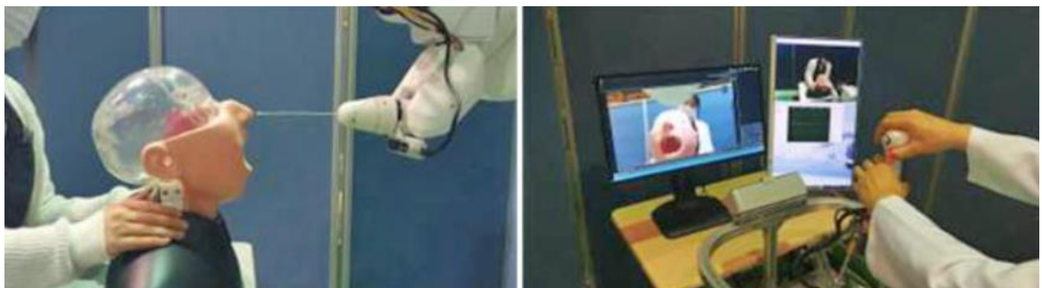
Obr. č. 40 Odoberanie vzoriek pomocou robota
